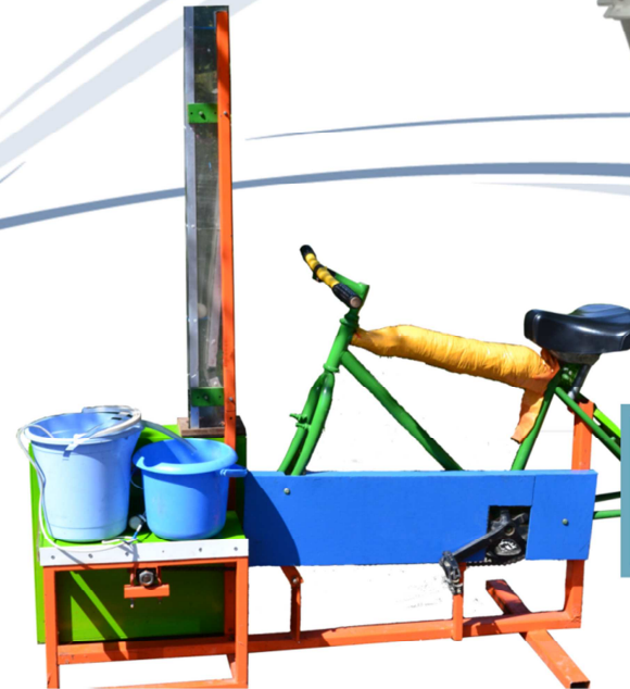
Vélo dynamique; La maquette permet de mettre en évidence la différence entre travail et puissance
